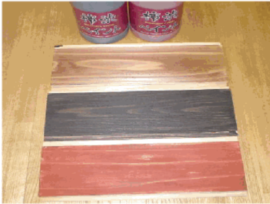
上から順に柿渋・柿渋ペイント黒 柿渋ペイント赤 の各色(木は杉)
